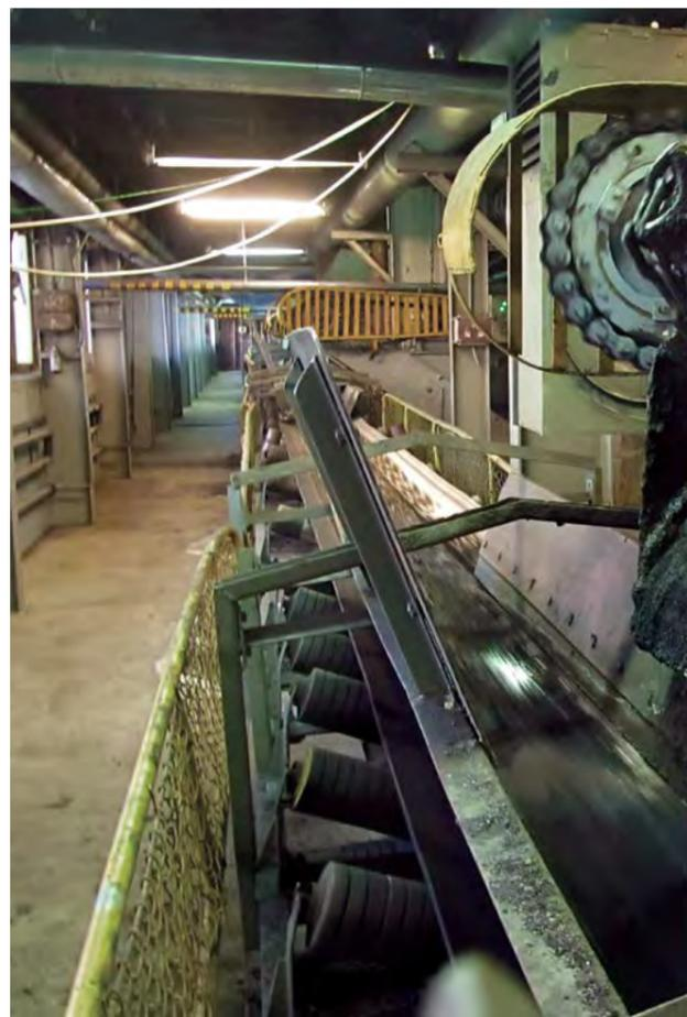
M.E.C.® M.O.R. (Medium Oil Resistant) è un nastro trasportatore con gomma di copertura con caratteristiche di media resistenza all'azione aggressiva degli oli, grassi vegetali e minerali. Resistente all'abrasione, alla lacerazione, ed agli agenti atmosferici.
