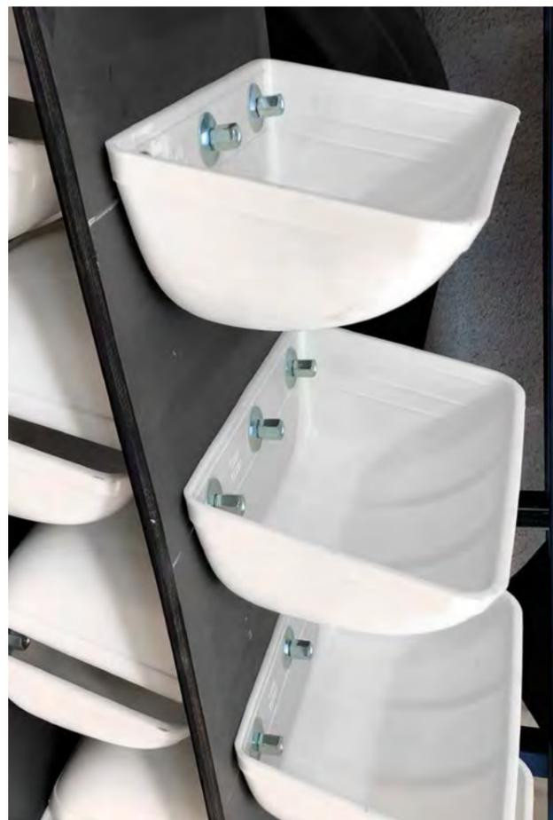
M.E.C.® Elevatorbande è un nastro trasportatore resistente agli agenti atmosferici che garantisce un'elevata resistenza alla trazione e un basso allungamento. È la scelta ideale nei processi lavorativi dove sia necessario eseguire trasporti di materiali in senso verticale. Il basso allungamento e la resistenza del nucleo tessile soddisfano contemporaneamente la funzione di supporto allo sforzo di trazione e di ancoraggio delle tazze che devono contenere il materiale.
