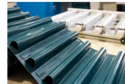
Applicazione in alta frequenza di onde in PVC per il settore agricolo.
