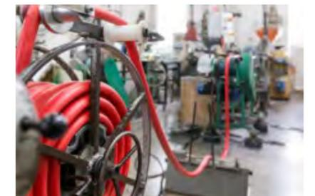
Particolare del processo di estrusione della guaina per rivestimento rulli realizzato all'interno del nostro stabilimento produttivo.
