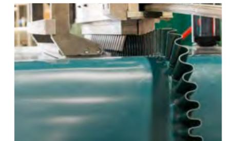
Sistema di contenimento laterale con sponde flessibili applicate senza base con tecnologia in alta frequenza.
