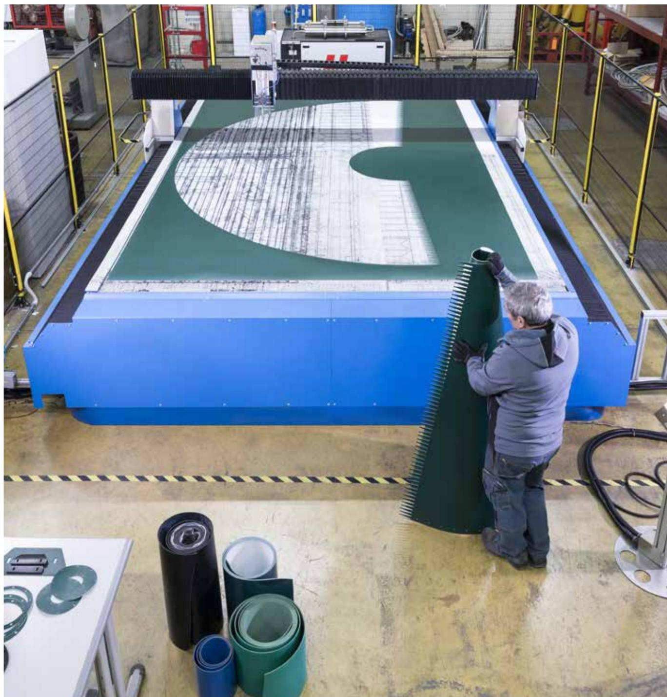
All'interno del nostro stabilimento produttivo realizziamo curve a nastro tramite waterjet con banco di lavoro 3x5 metri.
