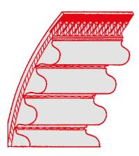
Le cinghie dentate M.E.C. ®Timing Polbelt passo 5M, 8M e 14M HTD con inserto metallico sono usate nelle trasmissioni a bassa potenza dove sono richiesti prodotti con tolleranze ristrette (ad esempio porte automatiche orizzontali e verticali). Le principali caratteristiche sono: resistenza all'abrasione e all'olio, l' uniformità di profilo (spessore, posizionamento inserto metallico, forma del dente), buona flessibilità.
