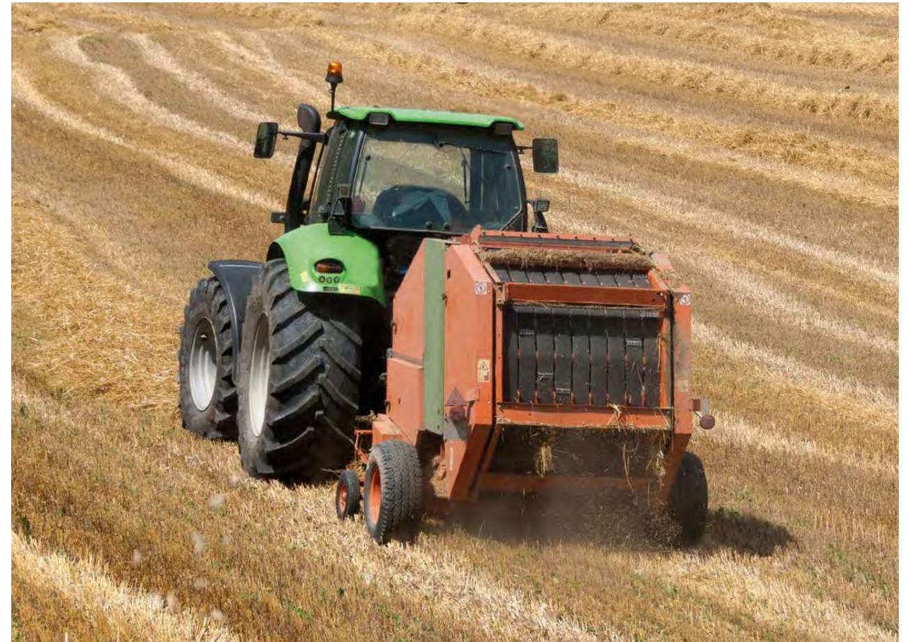
M.E.C.® Rotobande è un nastro appositamente studiato e realizzato per l'impiego su macchine rotopresse. Presenta un equilibrio ottimale tra rigidità e flessibilità, necessario per sollevare, arrotolare e compattare il prodotto.
