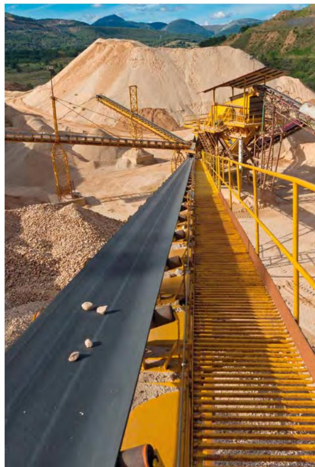
M.E.C.® Norbande è un nastro trasportatore universale adatto al trasporto dei più svariati materiali inerti. Il nucleo tessile garantisce un'elevata resistenza alla trazione ed un'ottima flessibilità trasversale.
