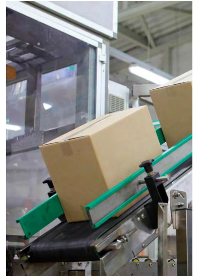
M.E.C.® Norbände strisciante /TR / M.O.R. sono nastri in gomma ad alta resistenza all'abrasione e agli agenti atmosferici. La trama garantisce un basso coefficiente di attrito della superficie inferiore (strisciante), una notevole rigidità trasversale e un'alta prestazione di marcia.
