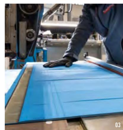
Sono costituite da una speciale lamina di nylon rivestita con gomma per garantire resistenza all'abrasione e linearità assoluta nel movimento.
